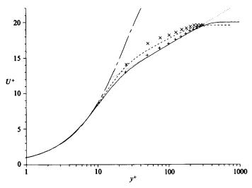
FIGURE 4. Mean velocity profiles. Present results: —,  $K = 1.5 \times 10^{-6}$ ; · · · ,  $\log (y^+)/0.40 + 5.2$ ; ---,  $K = 2.5 \times 10^{-6}$ ; ---, laminar flow. Jones & Launder: +,  $K = 1.5 \times 10^{-6}$ ; ×,  $K = 2.5 \times 10^{-6}$ .
